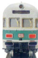
■ Lorsque la motrice pousse le convoi (voiture-pilote en tête), les signaux de tête à trois feux blancs de la voiture-pilote sont allumés. Lorsque la motrice est en tête, les deux feux arrière rouges de la voiture-pilote sont allumés.
