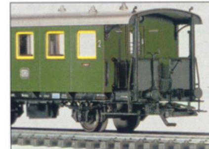
■ Attelages conducteurs spéciaux joints permettant l'éclairage intérieur standard dans tout le train à partir de la locomotive 3387/3687.
