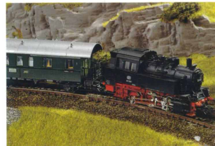
■ **3095 Locomotive-tender.** Série 74 de la Deutsche Bundesbahn. 3 essieux entraînés. 2 bandages d'adhérence. Crochets d'attelage avec pré-dételage à l'avant, attelage RELEX à l'arrière. Longueur hors tampons 13,5 cm.
