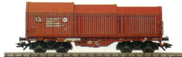
■ 4709 Coilwagen. Shimms van de Belgische Spoorwegen (NMBS/SNCB). Vaste fronten. 3 telescoopachtig verschuifbare huiven. 5 laadvakken met verstelbare bevestigingsarmen. 3 rollen staal als laadgoed. Draaistellen van DB-type. Extra bord op de langsdrager. Lengte over de buffers 13,8 cm.
