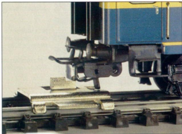
**7558 Aimants de véhicules.** 2 pièces. 10 x 10 x 3 mm. Pour déclenchement du contact de télécommande 7555. Pour voitures et wagons.
