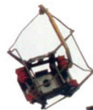
**■ 7207 Pantographe.** Type SBS 10 pour locomotives anciens modèles. Interchangeable avec 7218.
